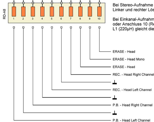
Bei Stereo-Aufnahme liegt die Löschespannung an Anschluss 8 und 10 an. Linker und rechter Löschkopf sind in Reihe geschaltet.
