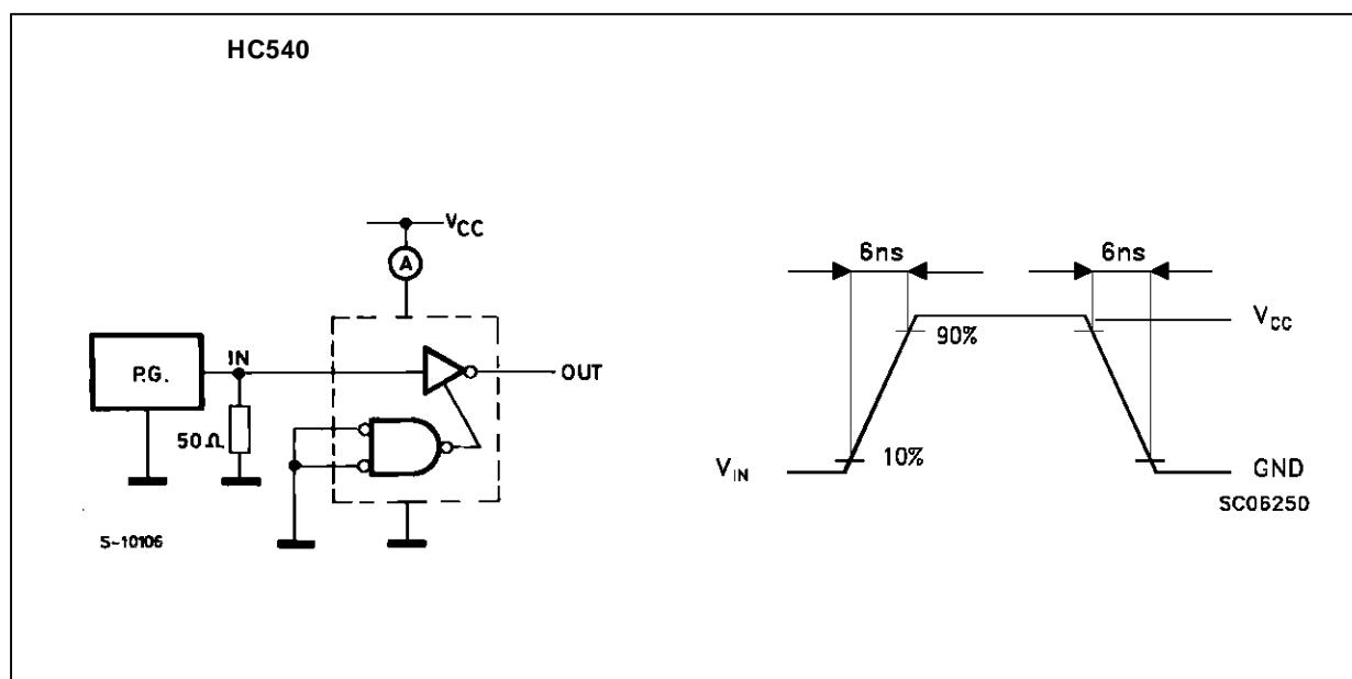
**SWITCHING CHARACTERISTICS TEST CIRCUIT**
